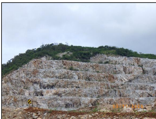
รูปที่ 2-11 การทำเหมืองแบบชั้นบันได
