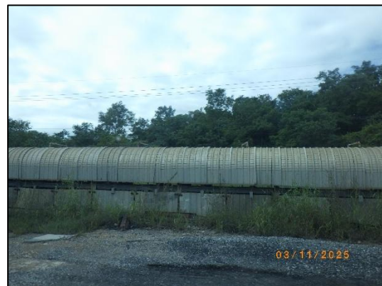
รูปที่ 2-45 สายพานลำเลียงที่ใช้ในการขนส่งหินจากโรง ย่อยหินเข้าสู่โรงงานปูนซีเมนต์
